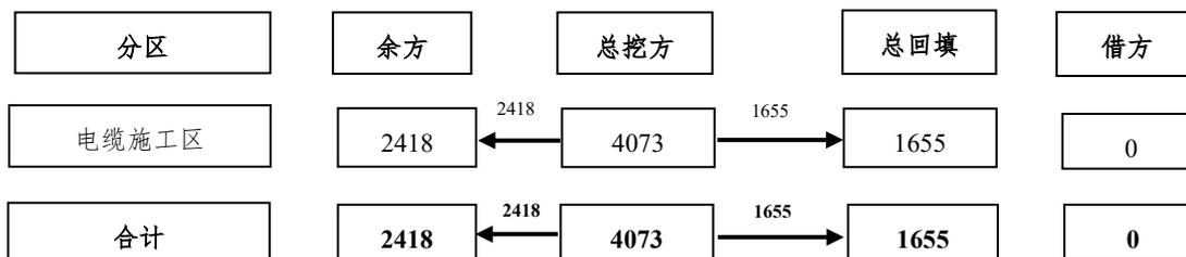
图 1.1-4 土石方平衡流向框图 单位：m<sup>3</sup>
