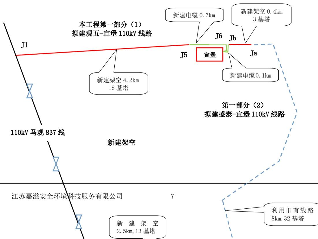
图 2-2 宣堡变电站配套线路路径走向示意图
